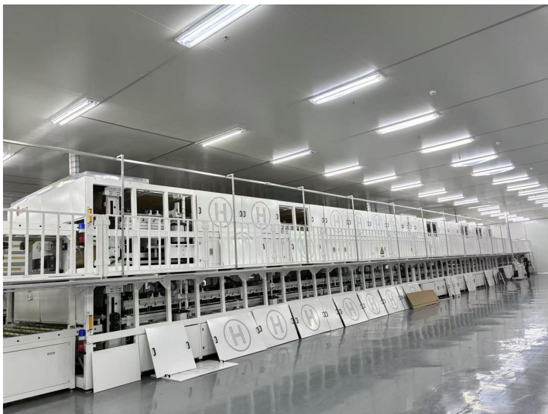
装框、灌胶、固化有机废气集气系统
