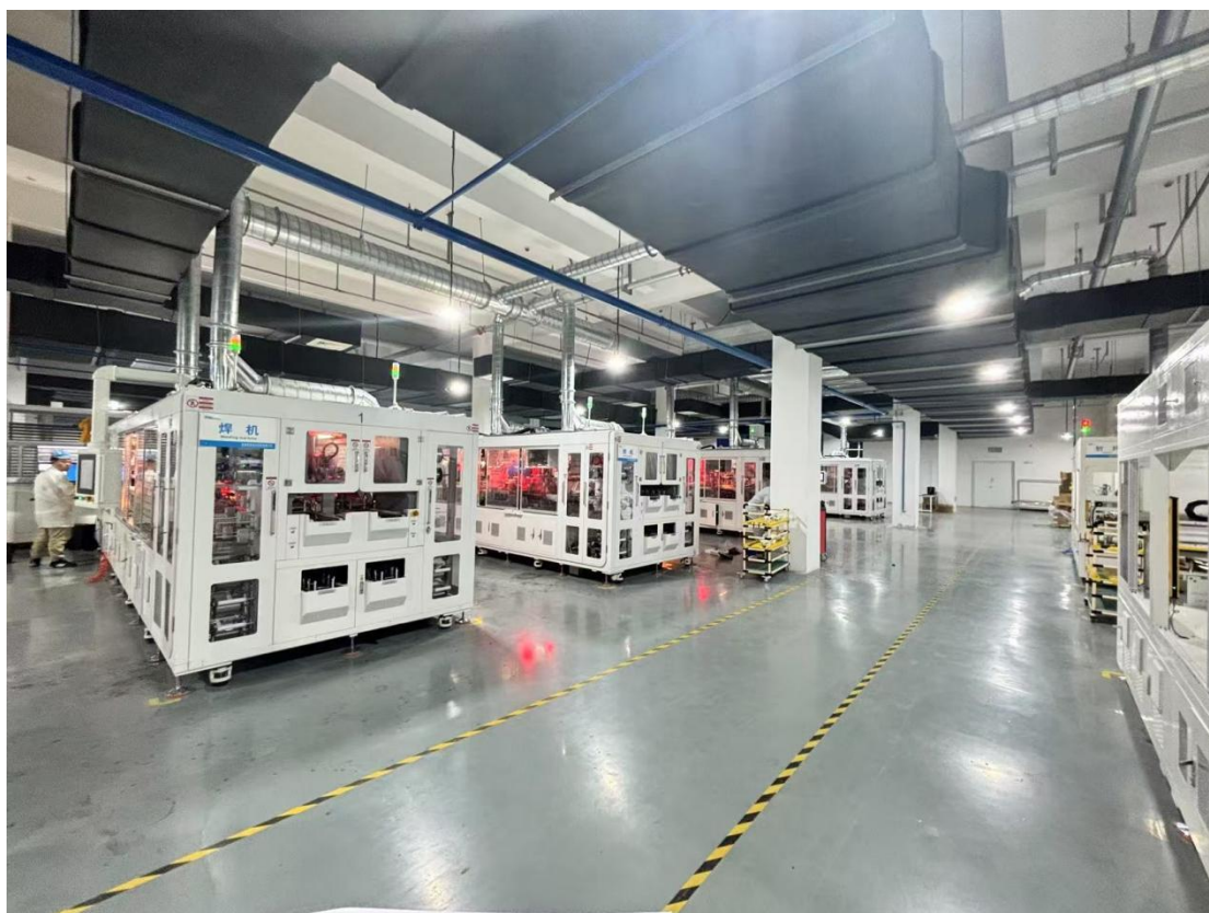
焊接烟尘集尘管道
